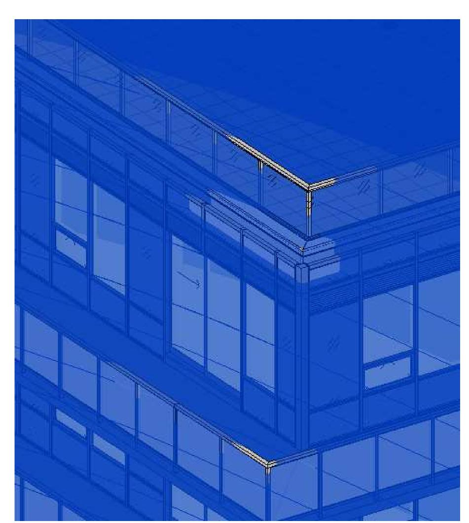
3D VIEW ILLUSTRATING THE PORTION OF GLASS RAILING ON LEVEL 11 THAT ENCROACH ON THE 30 M SETBACK REQUIREMENTS
